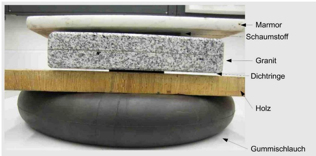
Figure 6: Dämpfung durch die Verwendung verschiedener Materialien [28, p. 22]
